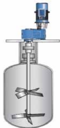
Цилиндрический привод с вынесенной опорой
