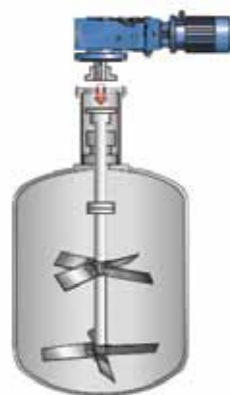
Стандартный коническо-цилиндрический привод
